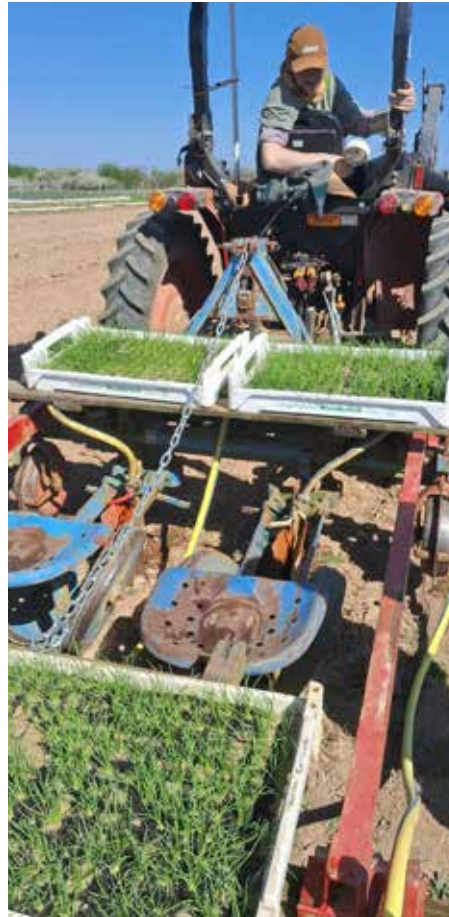
Wasserschlauch für Punkt Bewässerung an der Pflanzmaschine angebracht, Solawi Köln
