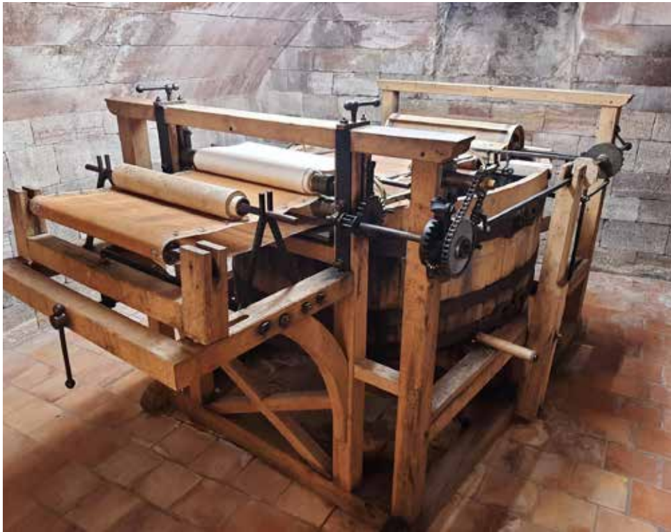
(Bild 2). Robertsche Maschine, Prototyp auf der Baseler Papiermühle Museum Ausstellung (Bild Tinoco 2024)
